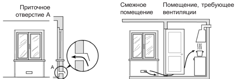
Пример обеспечения притока воздуха
