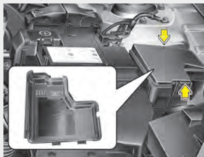
Панель плавких предохранителей в отсеке двигателя
