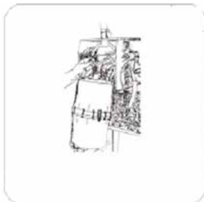
Отсоедините соединитель- ный кабель от нагрева- тельных элементов
