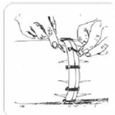
Снимите зажимы с фланцев
