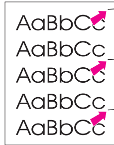
Повторяющиеся вертикальные дефекты
