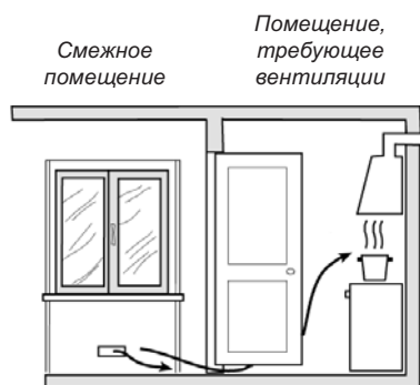
Обеспечение необходимого зазора между дверью помещения и порогом для свободного прохода приточного воздуха
