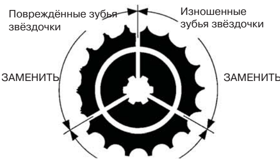
Исправные зубья звездочки ИСПРАВНО
