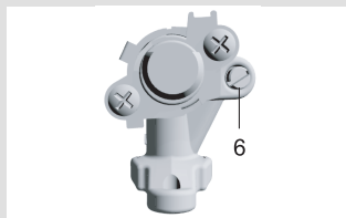
Горелка без газ-контроля (рис. 4)
