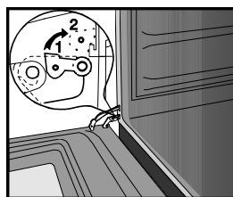
1 Шарнир дверцы при нормальном использовании
