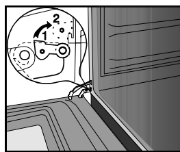
1 Петля дверцы при нормальном использовании
