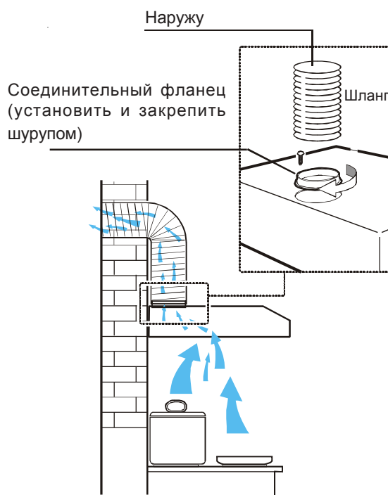
Рис. 1 - Работа прибора в режиме вытяжной вентиляции
