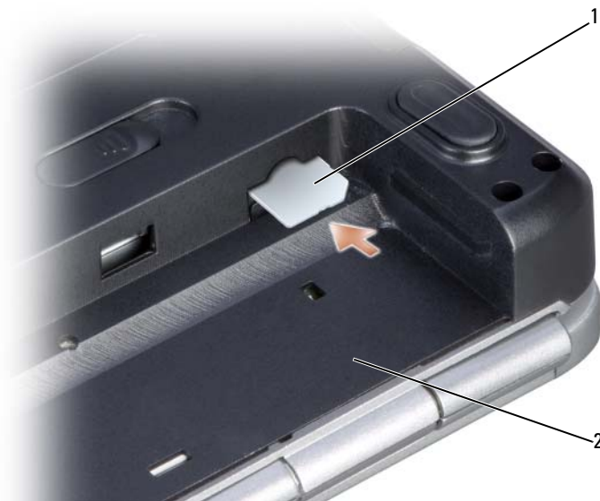
1 SIM-карта 2 отсек аккумулятора
