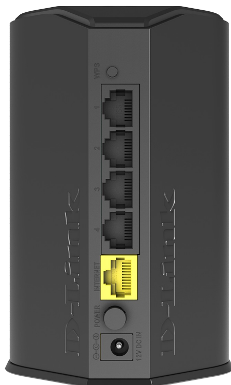
Рисунок 2. Вид задней панели DIR-300A.
