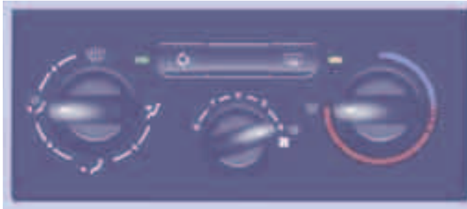
Панель управления отоплением
