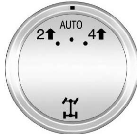
Раздаточная коробка без понижающей передачи
