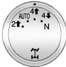
Раздаточная коробка с понижающей передачей
