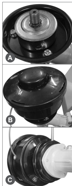
Рис. 6 Установка триммерной головки
