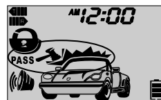
Отключена основная зона датчика
