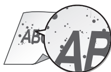
Aparecen manchas y salpicaduras de tóner
