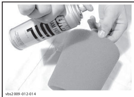
ТИПОВОЙ ПРИМЕР — НАНЕСЕНИЕ МАСЛА НА ПРЕДВАРИТЕЛЬНЫЙ ФИЛЬТРУЮЩИЙ ЭЛЕМЕНТ
