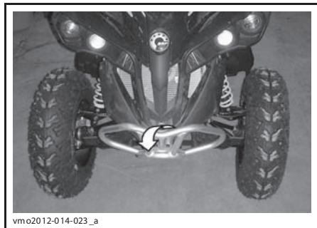
ТИПОВОЙ ВАРИАНТ — МЕСТО КРЕПЛЕНИЯ В ПЕРЕДНЕЙ ЧАСТИ МОТОВЕЗДЕХОДА
