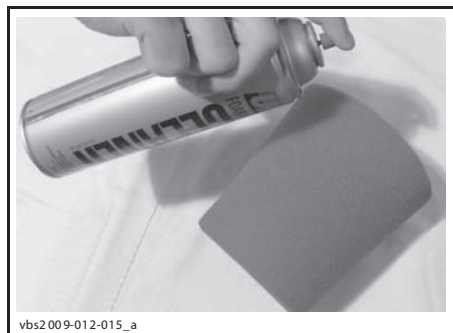
ЧИСТКА ПРЕДВАРИТЕЛЬНОГО ФИЛЬТРУЮЩЕГО ЭЛЕМЕНТА (ВНУТРИ И СНАРУЖИ)
