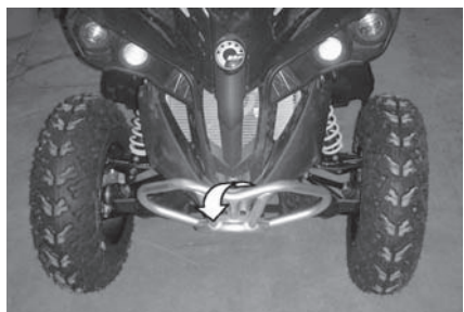
ТИПОВОЙ ВАРИАНТ — МЕСТО КРЕПЛЕНИЯ ПЕРЕДНЕЙ ЧАСТИ МОТОВЕЗДЕХОДА
