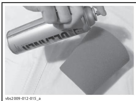
ТИПОВОЙ ВАРИАНТ — НАНЕСЕНИЕ ОЧИСТИТЕЛЯ НА ПРЕДВАРИТЕЛЬНЫЙ ФИЛЬТРУЮЩИЙ ЭЛЕМЕНТ
