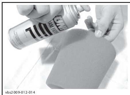
ТИПОВОЙ ВАРИАНТ — НАНЕСЕНИЕ МАСЛА НА ПРЕДВАРИТЕЛЬНЫЙ ФИЛЬТРУЮЩИЙ ЭЛЕМЕНТ
