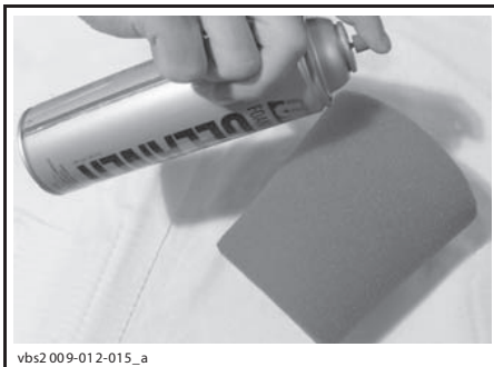
ЧИСТКА ПРЕДВАРИТЕЛЬНОГО ФИЛЬТРУЮЩЕГО ЭЛЕМЕНТА
