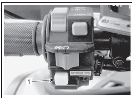
1. Кнопка изменения режимов работы усилителя рулевого управления (DPS)
