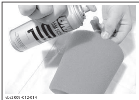
ТИПОВОЙ ВАРИАНТ — НАНЕСЕНИЕ МАСЛА НА ГУБЧАТЫЙ ФИЛЬТРУЮЩИЙ ЭЛЕМЕНТ
