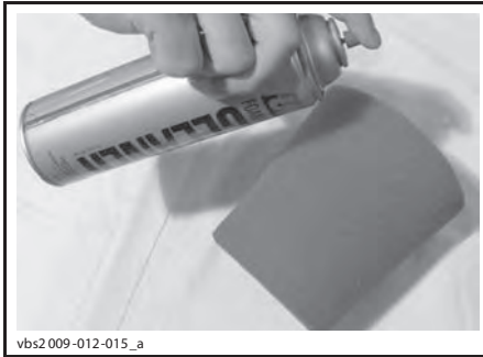
ТИПОВОЙ ВАРИАНТ — НАНЕСИТЕ НА ВНУТРЕННЮЮ И НАРУЖНУЮ ПОВЕРХНОСТИ ПРЕДВАРИТЕЛЬНОГО ФИЛЬТРУЮЩЕГО ЭЛЕМЕНТА СПЕЦИАЛЬНЫЙ ОЧИСТИТЕЛЬ
