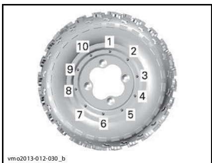
КОЛЕСА, ОСНАЩЕННЫЕ БЕДЛОКОМ С 10 БОЛТАМИ - ПОСЛЕДОВАТЕЛЬНОСТЬ ЗАТЯЖКИ (ИТОГОВЫЙ ШАГ)
