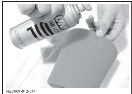
ТИПОВОЙ ВАРИАНТ — НАНЕСЕНИЕ МАСЛА НА ФИЛЬТРУЮЩИЙ ЭЛЕМЕНТ
