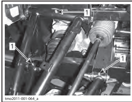
ПЕРЕДНЯЯ ПОДВЕСКА — ТИПОВОЙ ВАРИАНТ 1. Пресс-масленки
