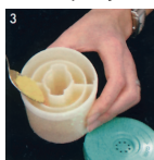
3 Заполнить фильтр- картридж новым гранулятом
