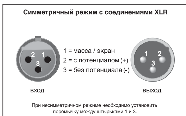
Рис. 4.1: Разъёмы XLR
