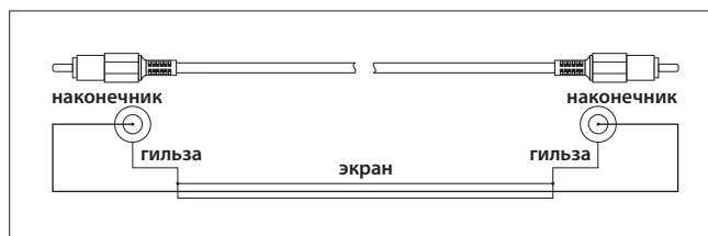
Рис. 4.4 Несимметричное подключение с помощью кабеля с RCA- разъемами
