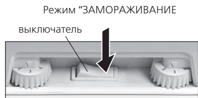
Рисунок 9 — Схема переключения режимов в холодильнике однокомпрессорном
