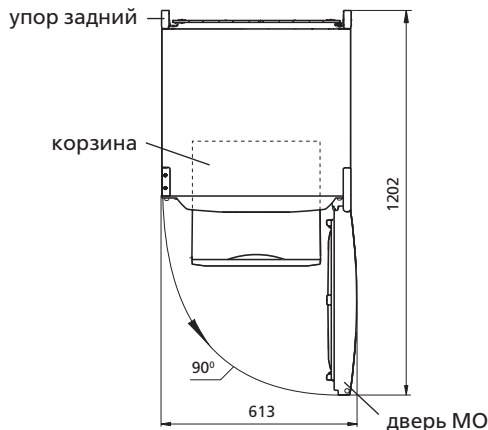
Рисунок 2 — Холодильник (вид сверху)
