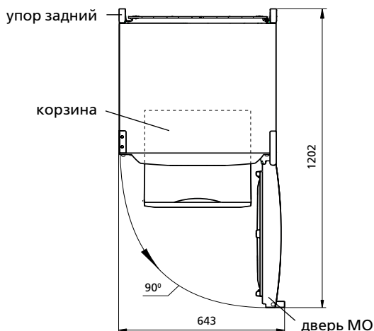
Рисунок 2 – Холодильник (вид сверху)
