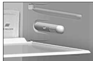
6-расм – СБнинг ҳарорат датчиги
